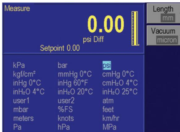
Die Serie 7050 verfügt über eine klare Menüstruktur mit intuitiven Navigationsfunktionen und Volltext-Beschreibungen für Menüs und Befehle. Das große Farbdisplay ermöglicht die gleichzeitige Anzeige der Druckwerte mit einer Untermenü-Auswahl, beispielsweise der oben gezeigten Bildschirmsicht zur Auswahl der Einheiten.
